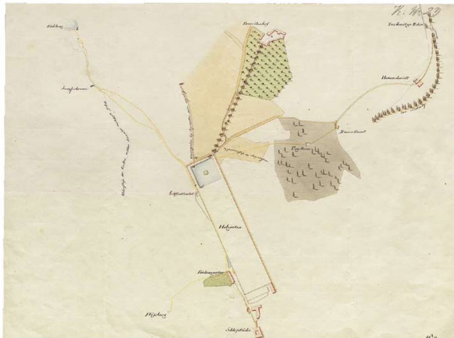
Obr. 101: Situační plán zámeckých vodovodů z doby okolo roku 1800. Zakresleny jsou vodovod z Dubíka, vodovod ze studny na Kvítkově dvoře a vodovod s vodním strojem a zásobní nádrží na ptačím hrádku. (nesignovaný plán No. 23, SOA v Třeboni, odd. Český Krumlov)
